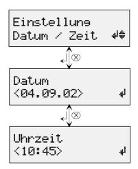
Wenn die Systemzeit nicht korrekt gestellt ist, werden die Berechnungen für die Positionierung der Fassadenprodukte (z.B. Lamellen) nicht korrekt ausgeführt.
