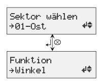
Nach der Funktion wird bei Höhe, Winkel oder Poisition ein weiteres Menü eingeblendet, um die Werte einzugeben.
