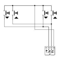
Ansteuerung von mehreren Kanälen mit einer oder mehreren Bedienstellen
